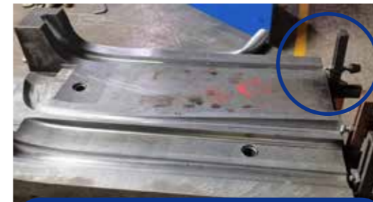
在成型模具叉端定位处增加型腔固定销。
