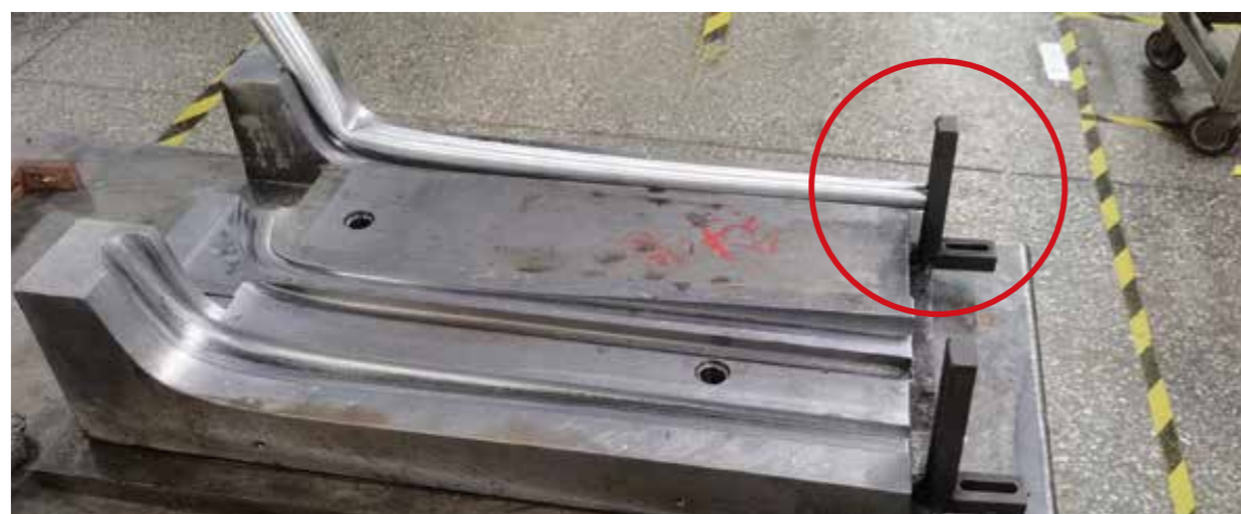
成型时，上模接触弯管处受压导致直处（钩爪端）上翘歪斜，造成管料成型时 10% 的报废。
