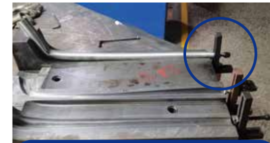
成型时将管料钩爪端插入定位销，可以防止弯管受压时不会导致管料上翘和压伤。
