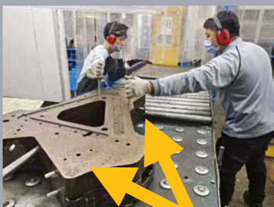
员工将开模孔当作拉模孔使用，因孔大小、深浅不一，铁棒容易脱落伤到手
